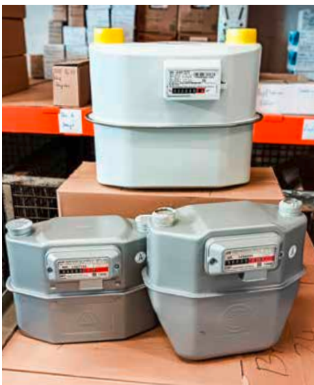
Unterschiedlich große Gaszähler. Auf dem kleinen Feld auf der Vorderseite sind die Zählernummer und der Zählerstand verbaut.
